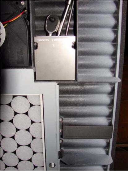
8. Introduza a ferramenta na abertura e rode o parafuso no sentido contrário ao dos ponteiros do relógio, até o digitalizador ficar levantado cerca de 1,5-2 cm e encontrar resistência.
